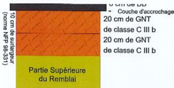
La Partie Supérieure du Remblai sera réalisée en matériaux insensible à l'eau ( $VBS \leq 0,1$ ).
