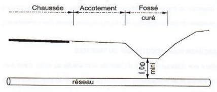
Le remblaiement du fossé se fera à l'aide de matériaux étanche et de façon à ce que le fil d'eau ne présente aucune contre pente ou point bas.
