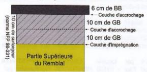
La Partie Supérieure du Remblai sera réalisée en matériaux insensible à l'eau (VBS ≤ 0.1).
