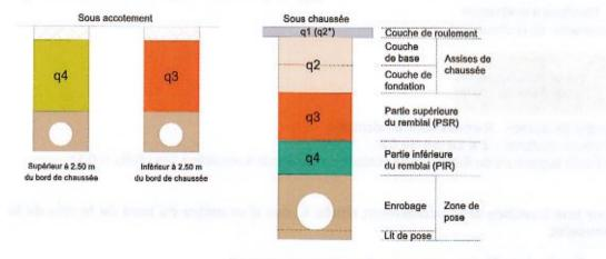
(\*) l'objectif q1 ne peut être atteint avec le matériel utilisé pour le compactage des tranchées. On se limite à un objectif q2, compensé en partie par une surépaisseur de 10% de la couche de roulement
