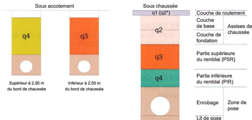
(\*) l'objectif q1 ne peut être atteint avec le matériel utilisé pour le compactage des tranchées. On se limite à un objectif q2, compensé en partie par une surépaisseur de 10% de la couche de roulement
