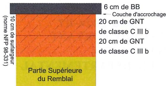
La Partie Supérieure du Remblai sera réalisée en matériaux insensible à l'eau ( $VBS \leq 0.1$ ).
