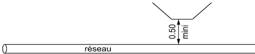
Le remblaiement du fossé se fera à l'aide de matériaux étanche et de façon à ce que le fil d'eau ne présente aucune contre pente ou point bas.
